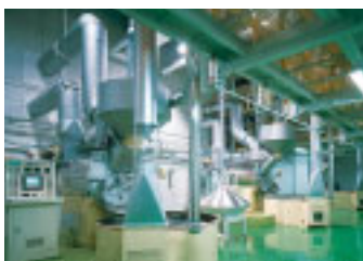
オリジナルの直火焙煎機 Exclusive direct-heating equipment
